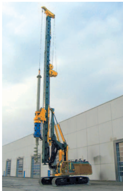
метод бурения «Келли» с RG 25 S Kelly drilling mode on RG 25 S (Germany)
