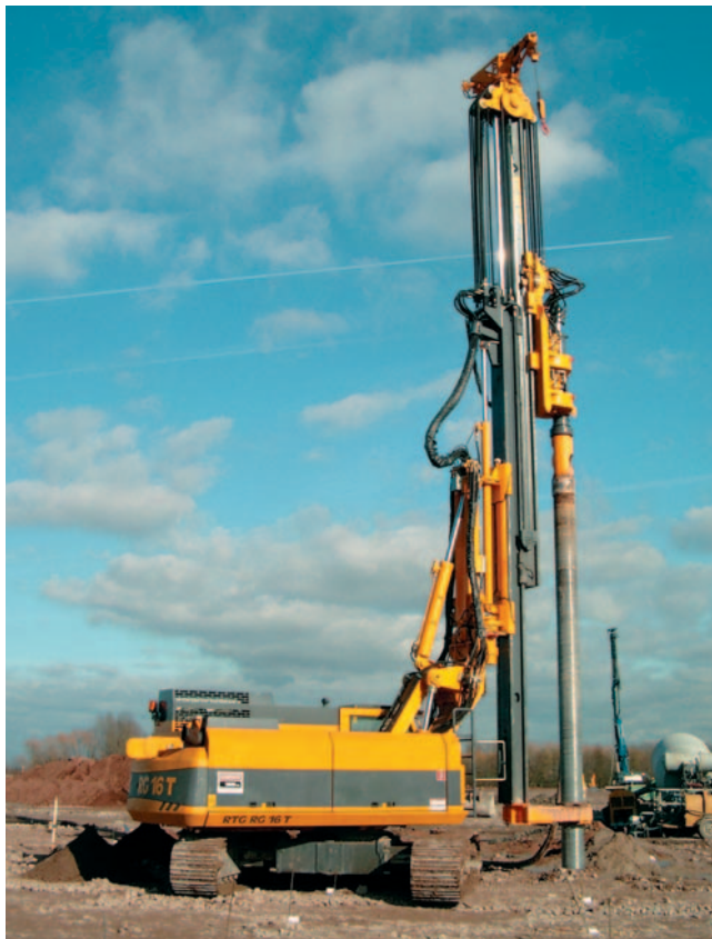
RG 16T с двумя приводами DKS 40/60 г. RG 16T with twin rotary drive DKS 40/60 (Chester, UK)
