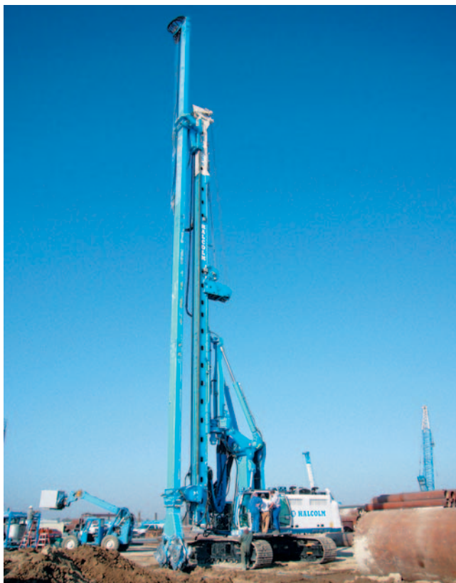
CSM составляющая BCM 5 на RG 25S CSM unit BCM 5 on RG 25 S (USA)
