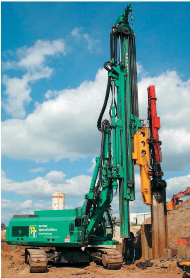
RG 16 T с дизельным молотом для создания шпунтовых стен RG 16 T with Diesel hammer for driving sheet piles (Germany)
